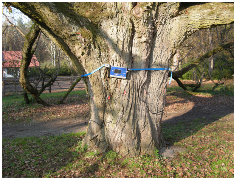
Rycina 9. Pień Tilia cordata Mill. z założonymi sensorami i jednostką centralną (fot. W. Durlak) Figure 9. Tilia cordata Mill. trunk with sensors and central unit installed (photo by W. Durlak)
