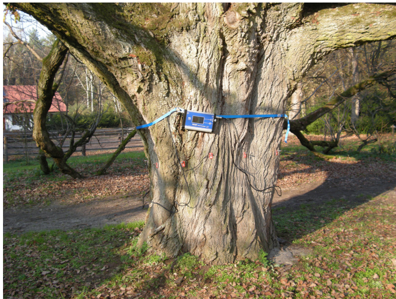
Rycina 9. Pień Tilia cordata Mill. z założonymi sensorami i jednostką centralną (fot. W. Durlak) Figure 9. Tilia cordata Mill. trunk with sensors and central unit installed (photo by W. Durlak)
