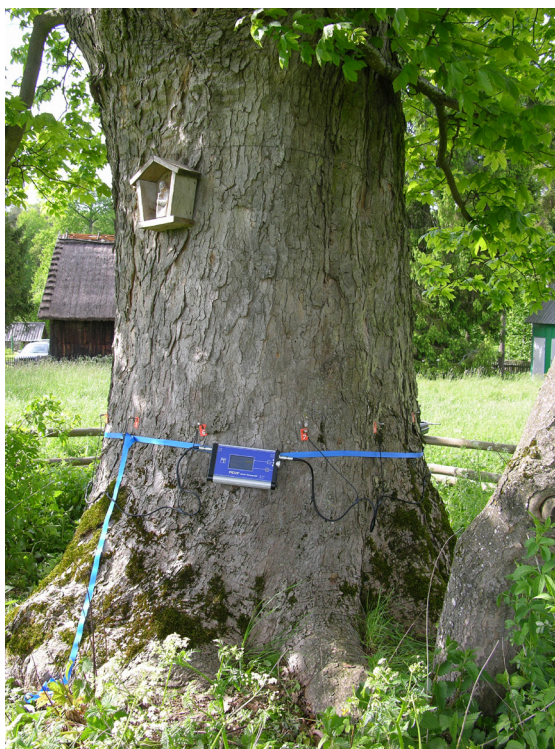
Rycina 3. Pień Acer pseudoplatanus L. podczas pomiaru tomografem dźwiękowym PiCUS® 3 (fot. W. Durlak) Figure 3. The trunk of Acer pseudoplatanus L. during measurement with the PiCUS 3 sonic tomograph (photo by W. Durlak)
