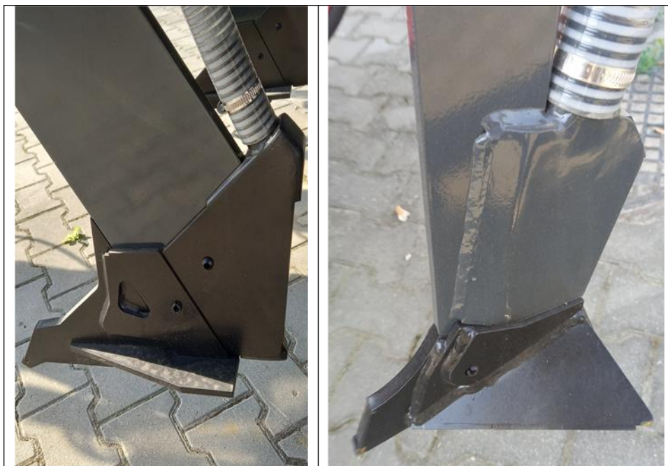
Ryc. 1. Widok ogólny zęba spulchniającego z aplikatorem nawozów (z lewej) i redlicą wysiewającą nasiona (z prawej)
