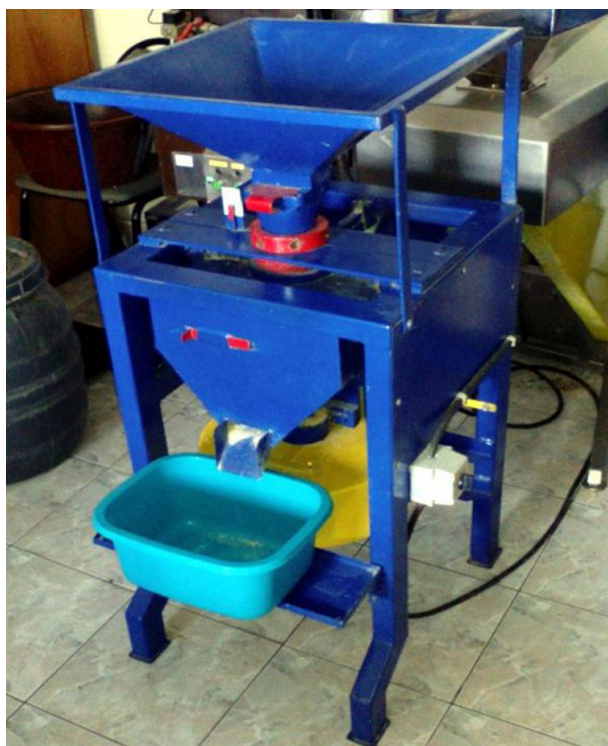
Rys. 1. Obłuskiwacz dolnobiegunowy Fig. 1. A low-level huller
