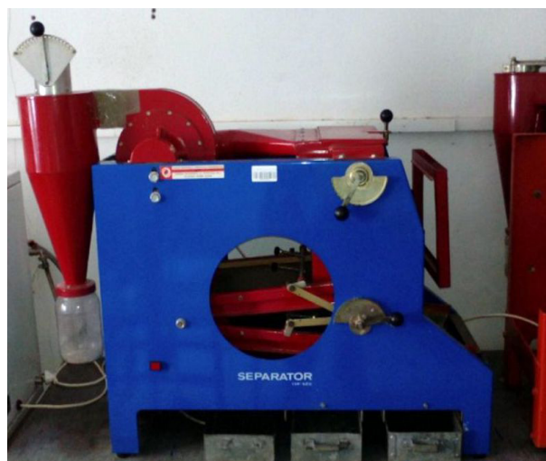
Rys. 2. Laboratoryjny separator sitowo-pneumatyczny Fig. 2. Laboratory sieve-pneumatic separator
