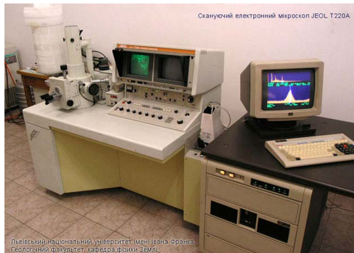
Fig. 1. Scanning electronic microscope JEOL T220A Rys. 1. Mikroskop elektronowy skaningowy JEOL T220A
