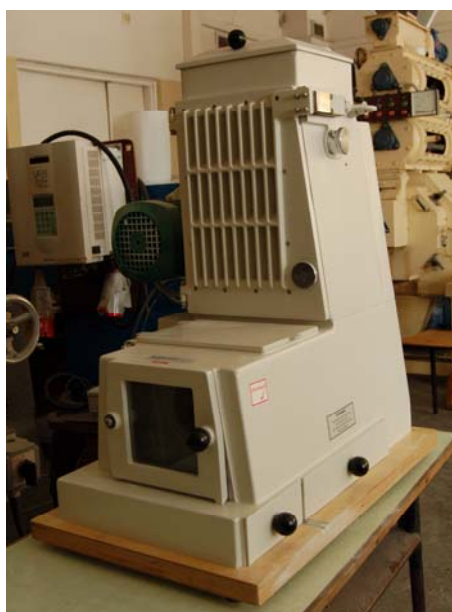
Rys. 3. Mlewnik laboratoryjny Brabender Quadrumat Junior Fig. 3. Laboratory mill Brabender Quadrumat Junior
