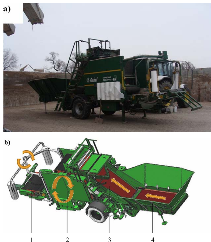
Rys. 1. Prasa Orkel MP 2000 Compactor: a) widok ogólny, b) schemat budowy: 1 – owijarka, 2 – komora zwijania, 3 – przenośnik pochyły, 4 – kosz zasypowy
