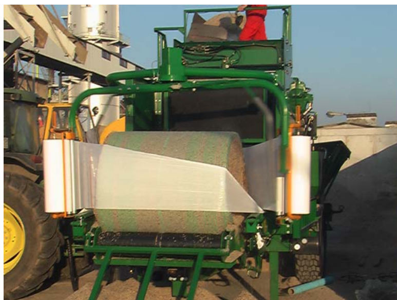
Rys. 3. Owijanie uformowanej beli folią rozciągliwą
