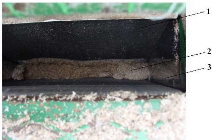
Rys. 2. Ukształtowanie komory zwijania w początkowej fazie pracy (widok od góry): 1 – owijarka, 2 – zwijany materiał, 3 – boczna ściana komory zwijania
