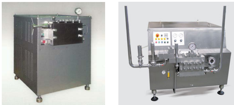
Rys. 4. Homogenizator firmy Spomasz Bełżyce S.A (wydajność do 10 000 l/godz.) oraz homogenizator firmy Technomix.
