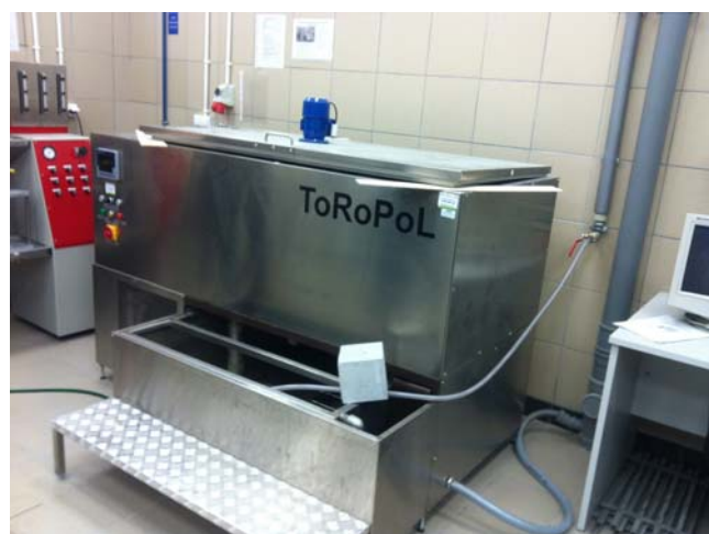
Fot. 2. Komora służąca do badania mrozoodporności materiałów budowlanych Phot. 2. Chamber for frost resistance testing of building materials
