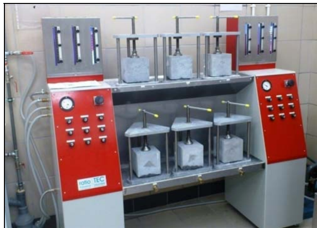
Fot. 1. Stanowisko do badań głębokości penetracji wody w betonie Phot. 1. Device for investigation on water penetration depth in concrete
