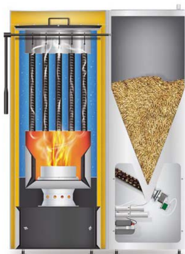
Rys. 7. Budowa kotła przystosowanego do spalania peletów [www.hkslazar.pl] Fig. 7. Furnace construction accommodated for pellets combustion
