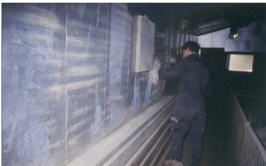
Rys. 2. Zmywanie zapylonego ekranu refleksyjnego, wyłożonego na wszystkich ścianach i suficie tuczarni Fig. 2. The wash of polluted reflective screen, lined on all walls and ceiling of the building for livestock
